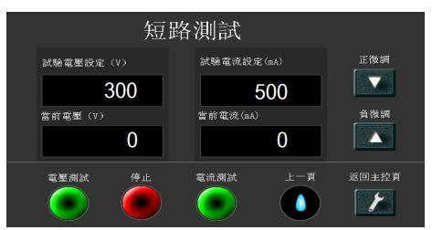
B. 点击试验电压设定和试验电流设定下框中数字的部位,系统会弹出键盘,按照试验要求输入相应数字,点 ENT 确定及关闭键盘(如下图):
