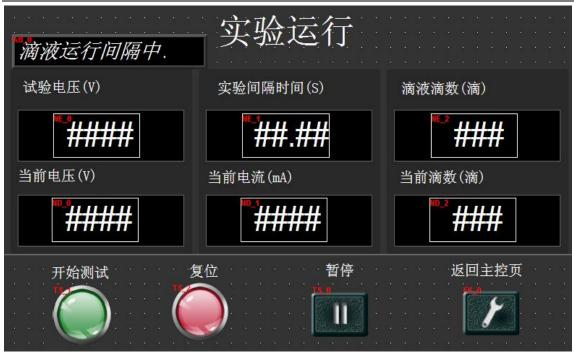
B. 点击上方该设定黑框中显字部位,系统会跳出键盘,输入对应数字(试验电压为你设定的按标准要求设定,实实验间隔时间为 30S,滴液滴数按标准要求设定),下方为显示值,点 ENT 确定及关闭键盘;
