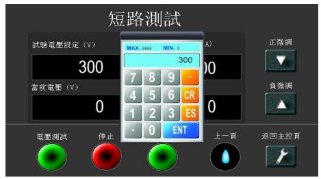
c. 点击电压测试按钮 , 系统会自动启动加压机构,逐步上升到默认电压值(设定好试验电压值后,要将电压选择12旋钮调到对应的位置,
